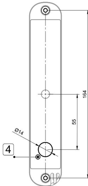
Montieren Sie die Anzeige im Bereich der Sitzbänke und halten Sie einen Abstand von mindestens 30cm zwischen Kabinendecke und Oberkante des Geräts ein.
