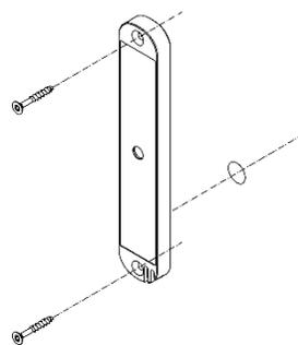
Schrauben Sie nun das Gerät mit den zwei mitgelieferten Senkkopfschrauben auf die Kabinenwand. **Schrauben vorbohren!**
